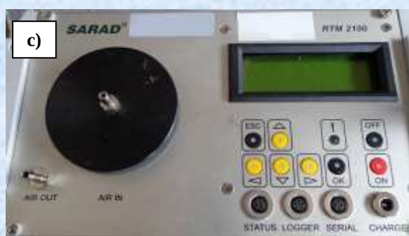
FIGURAS 3. Equipos de medida de radón: Safety Siren Pro Series 3 a) , SARAD SCOUT b) , SARAD RTM-2100 c) y AlphaGUARD d) . (Fuente: elaboración propia)
