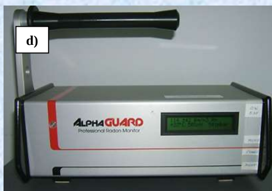
FIGURAS 3. Equipos de medida de radón: Safety Siren Pro Series 3 a) , SARAD SCOUT b) , SARAD RTM-2100 c) y AlphaGUARD d) . (Fuente: elaboración propia)
